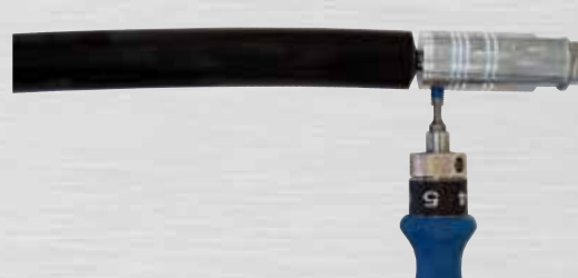
Bild 116: Gewindestift B mit 4 Nm anziehen
