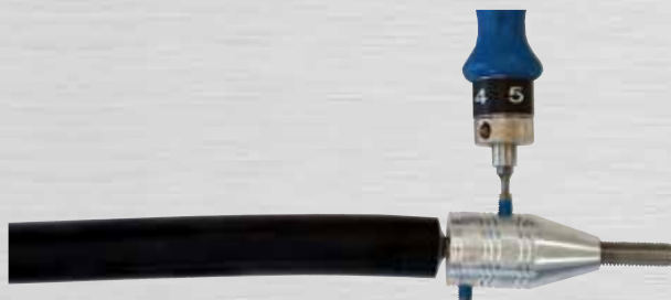
Bild 108: Gewindestift A mit 4 Nm anziehen
