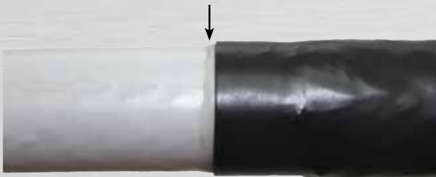
Bild 120: Kleberaustritt am Schutzmantel
