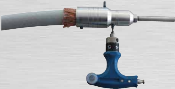
Bild 144: Gewindestift A mit 4 Nm anziehen
