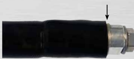
Bild 130: Gewindestifte müssen verdeckt und der Kleber ausgetreten sein
