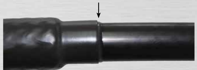
Bild 121: Kleberaustritt an der Schwarzschrift
