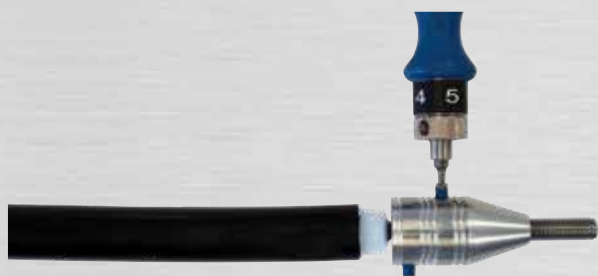
Bild 31: Gewindestift A mit 4 Nm anziehen
