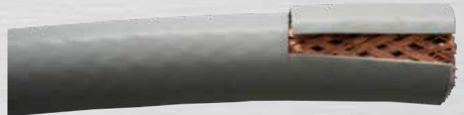
Bild 132: Abziehen des Schutzmantels
