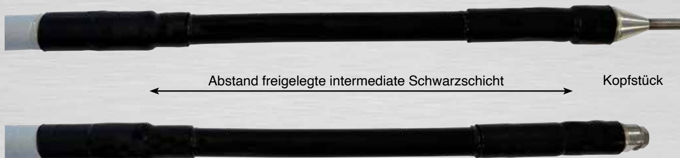
Bild 84: fertig konfektionierter Kopfbereich
