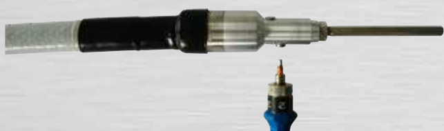
Bild 79: Zylinderkopfschraube A mit 6 Nm anziehen
