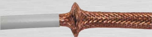
Bild 12: Bildung einer Wölbung mit ausreichender Höhe
