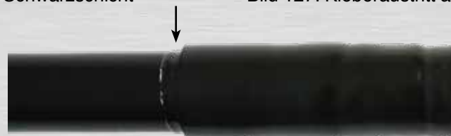
Bild 128: Kleberaustritt an der Schwarzschrift
