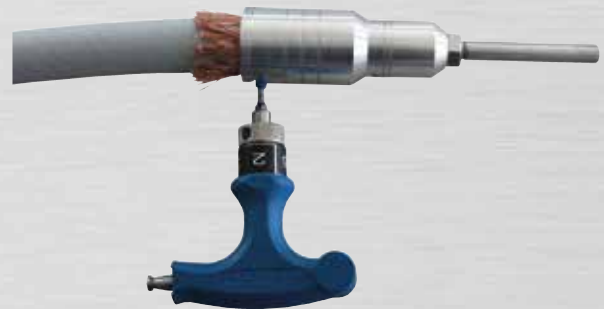
Bild 147: Gewindestift C mit 2,5 Nm anziehen
