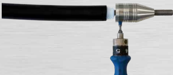
Bild 33: Gewindestift B mit 4 Nm anziehen
