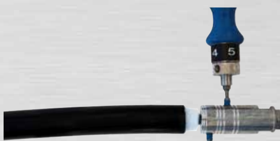
Bild 38: Gewindestift A mit 4 Nm anziehen
