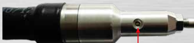
Bild 78: Sichtprüfung des Innenleiters
