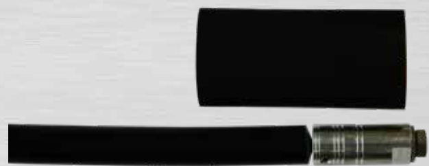
Bild 125: Positionierung des Schrumpfschlauches
