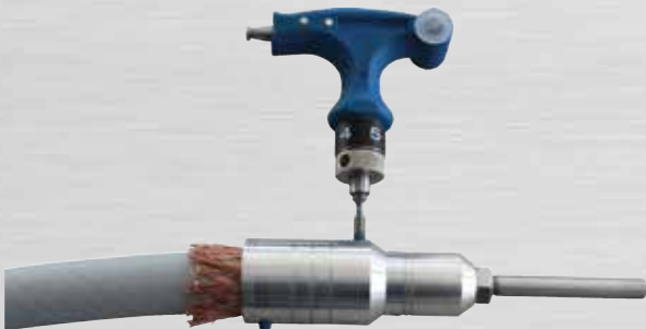
Bild 146: Gewindestift B mit 4 Nm anziehen
