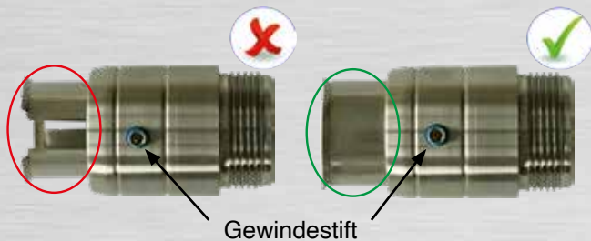
Bild 67: Richtige Positionierung des Kontaktblechs
