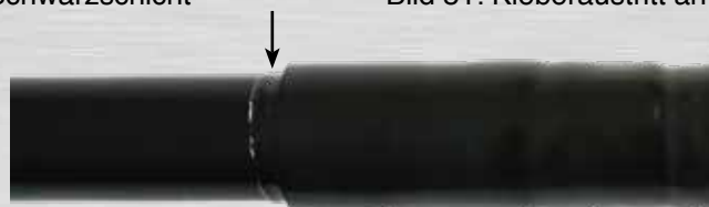
Bild 52: Kleberaustritt an der Schwarzschrift
