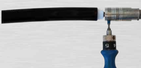
Bild 40: Gewindestift B mit 4 Nm anziehen
