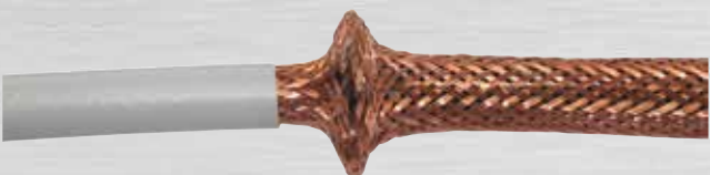
Bild 92: Bildung einer Wölbung mit ausreichender Höhe
