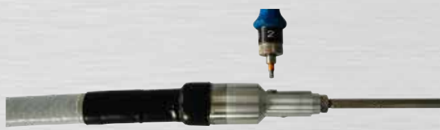
Bild 80: Zylinderkopfschraube B mit 6 Nm anziehen
