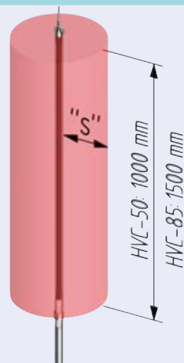
Bild 152: Länge "L" der freigelegten intermediären Schwarzschrift (siehe oben) oder 2x Trennungsabstand "s" in Luft
