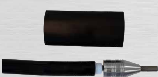
Bild 46: Positionierung des Schrumpfschlauches
