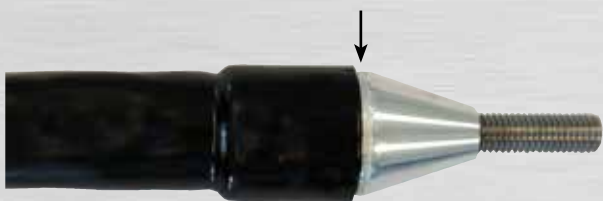
Bild 129: Gewindestifte müssen verdeckt und der Kleber ausgetreten sein
