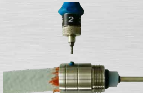
Bild 70: Gewindestift bündig einschrauben
