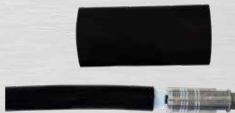
Bild 49: Positionierung des Schrumpfschlauches
