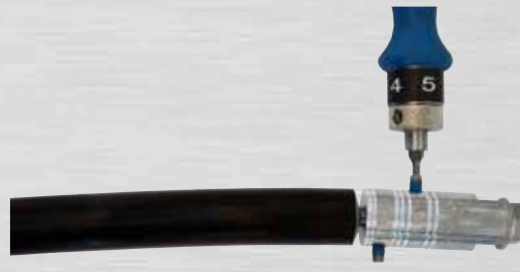
Bild 114: Gewindestift A mit 4 Nm anziehen
