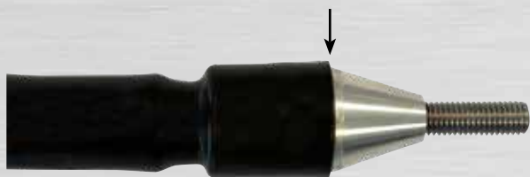
Bild 53: Gewindestifte müssen verdeckt und der Kleber ausgetreten sein
