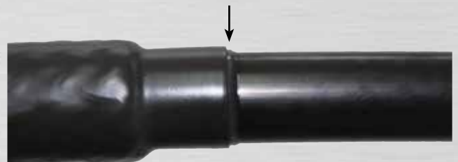
Bild 45: Kleberaustritt an der Schwarzschrift
