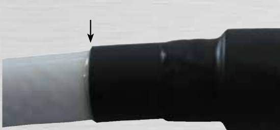
Bild 150: Kleberaustritt am Schutzmantel
