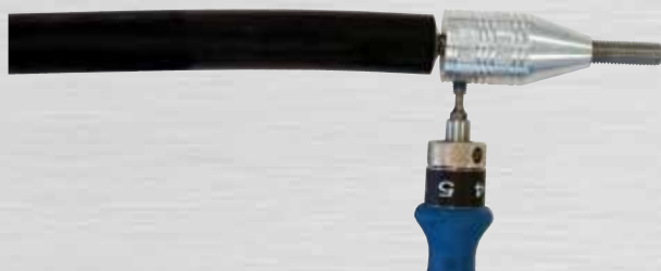
Bild 110: Gewindestift B mit 4 Nm anziehen
