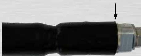
Bild 54: Gewindestifte müssen verdeckt und der Kleber ausgetreten sein
